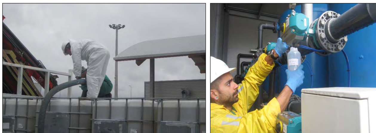
Figura 13- Immagini del test con GAC a scala industriale: omogeneizzazione (sin) campionamento (dx)
