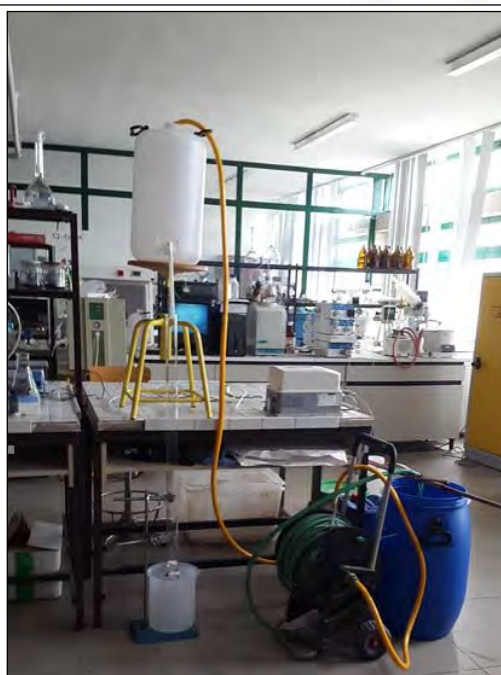
Figura 8 – Schema e vista dell'impianto adsorbimento GAC nel 1° test a scala laboratorio (0,5L)
