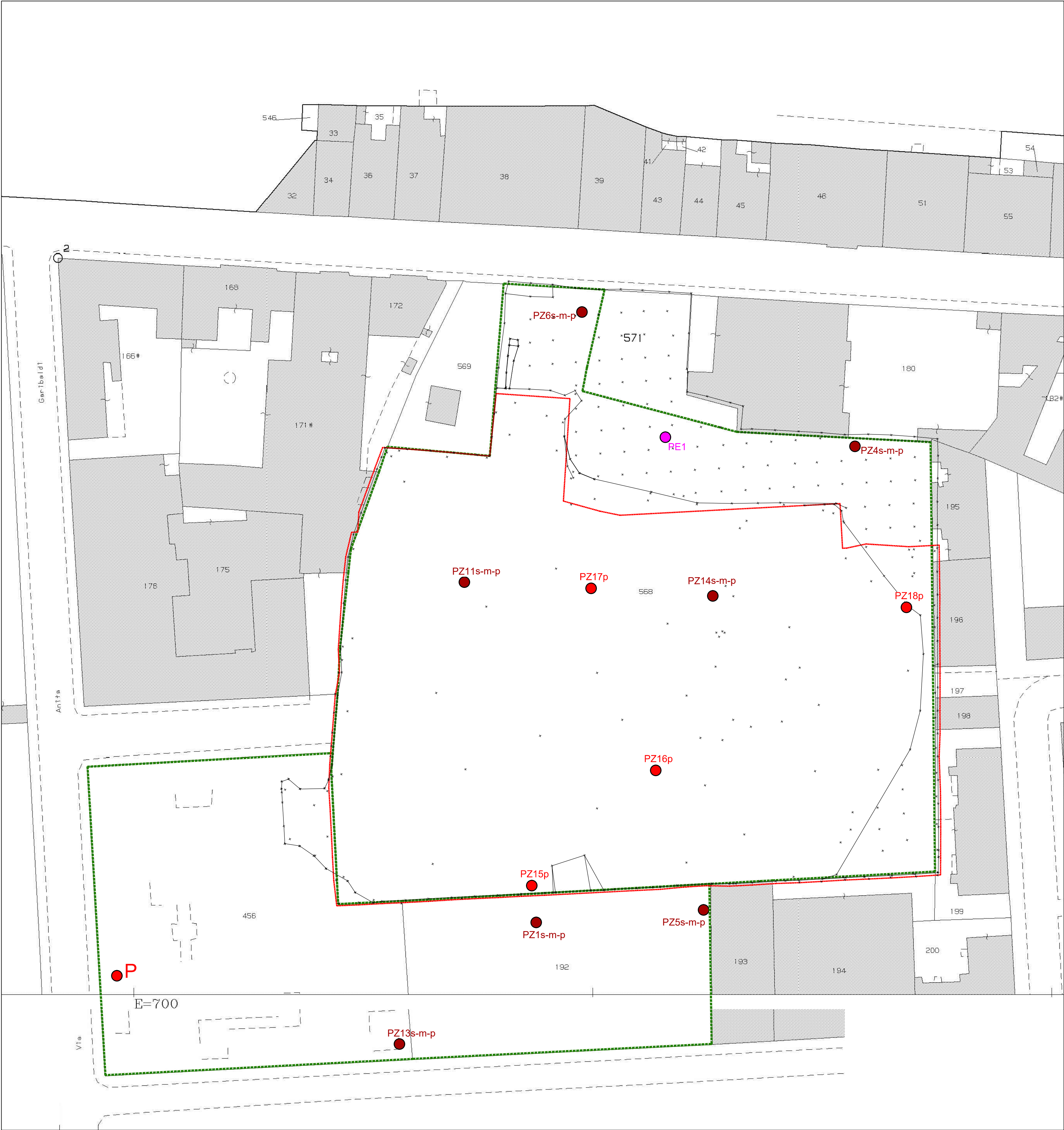
SCHEMA PLANIMETRICO SISTEMA DI BONIFICA FALDA E LOCALIZZAZIONE PUNTI DI MONITORAGGIO INTERNI AL SITO Scala 1:500
