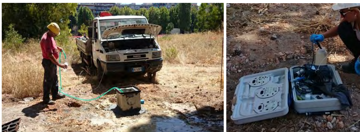
Figura 7 – Campionamento di acqua di falda e rilievi chimico-fisici on site con sonda multi-parametrica
